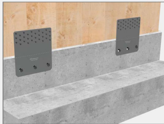
Giunzione cemento-legno con piastra TITAN
