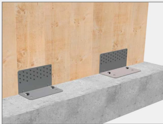
Giunzione cemento-legno con angolare TITAN
