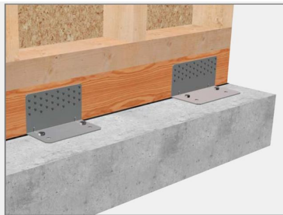
Fissaggio trave di banchina
